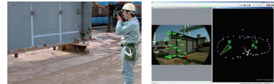
①一眼レフデジタルカメラ撮影 ②画像ファイルを自動解析
